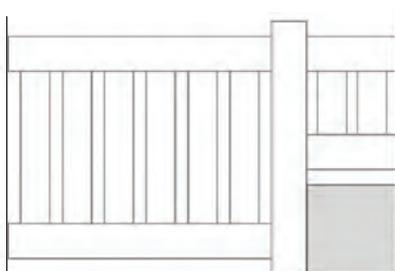
**Descriptif** : pose d'un poteau intermédiaire contre la boîte aux lettres. Pour une hauteur de clôture inférieure à 600 mm, la fabrication de l'élément du dessus devient délicate.
