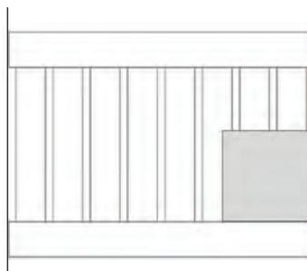
**Descriptif** : la boîte aux lettres est intégrée dans l'élément et repose sur la traverse basse. Il faut siliconer les barreaux sur la B.A.L. pour en assurer le maintien en partie basse.
