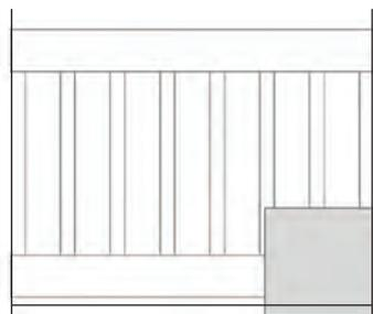
**Descriptif** : la boîte aux lettres est intégrée dans l'élément et repose sur le muret. Pose d'une patte inox ou aluminium sur la B.A.L. pour la traverse basse. Il faut siliconer les barreaux sur la B.A.L. pour en assurer le maintien en partie basse.
