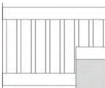
**Descriptif** : la boîte aux lettres est intégrée dans l'élément et repose sur le muret. La traverse basse est fixée avec des pattes inox ou PVC sur la B.A.L. La traverse posée sur la B.A.L. est bouchée en son extrémité par un bouchon plat. Cette configuration n'est réalisable que si l'extrémité de la B.A.L. tombe dans un « entre barreaux ».
